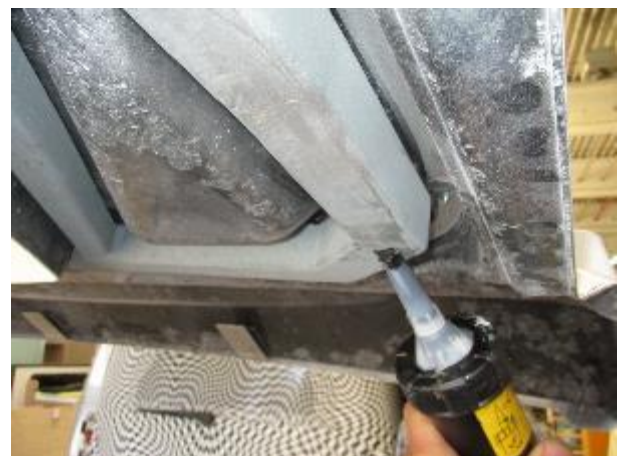
Bild 15.0 Kleberaube am Rahmen ziehen
