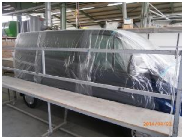
Bild 4.0 Abdecken der Außenhaut
